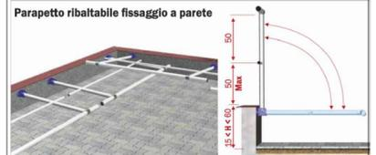
Parapetto ribaltabile a 90 gradi, installato sul muretto di bordo
