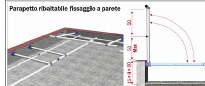
Parapetto ribaltabile a 90 gradi, installato sul muretto di bordo
