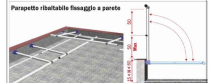
Parapetto ribaltabile a 90 gradi, installato sul muretto di bordo
