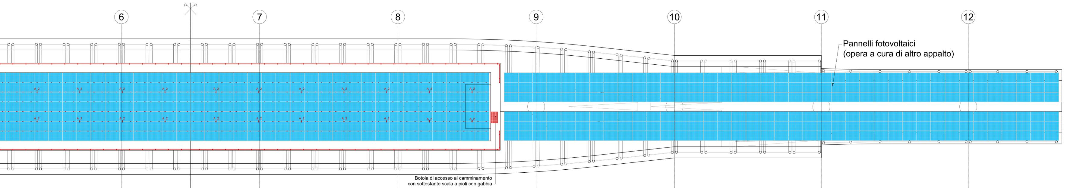
PIANTA QUOTA COPERTURA CON PANNELLI FOTOVOLTAICI scala 1:200
