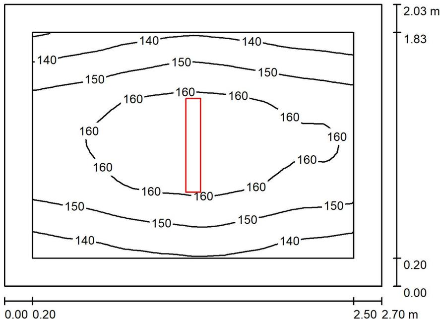
Altezza locale: 3.500 m, Altezza di montaggio: 3.500 m, Fattore di manutenzione: 0.80
