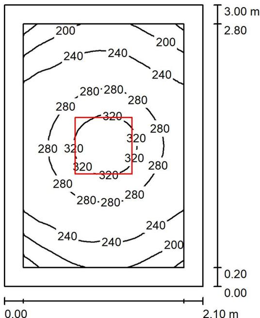
Altezza locale: 3.460 m, Altezza di montaggio: 2.800 m, Fattore di manutenzione: 0.80
