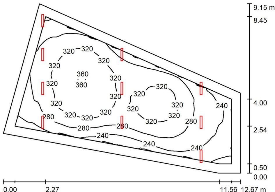
Altezza locale: 3.500 m, Altezza di montaggio: 3.500 m, Fattore di manutenzione: 0.80
