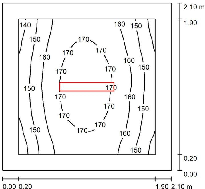
Altezza locale: 3.460 m, Altezza di montaggio: 3.460 m, Fattore di manutenzione: 0.80
