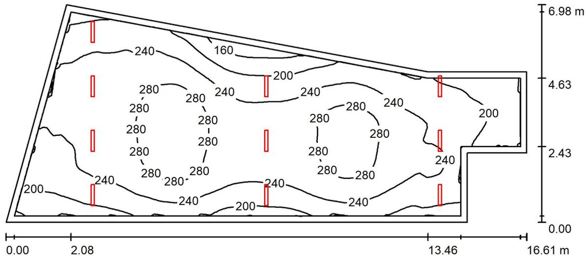
Altezza locale: 3.500 m, Altezza di montaggio: 3.500 m, Fattore di manutenzione: 0.80
