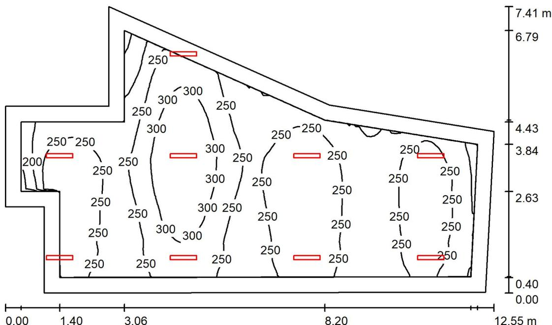
Altezza locale: 3.500 m, Altezza di montaggio: 3.500 m, Fattore di manutenzione: 0.80
