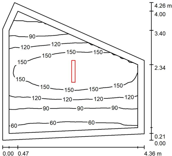
Altezza locale: 3.500 m, Altezza di montaggio: 3.000 m, Fattore di manutenzione: 0.80
