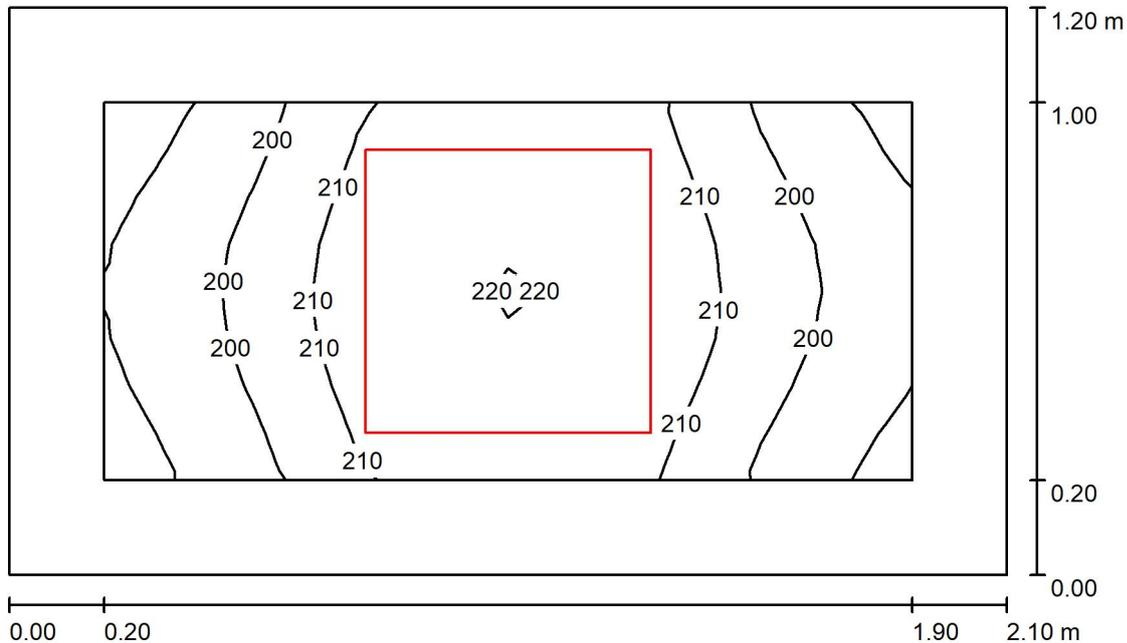
Altezza locale: 3.460 m, Altezza di montaggio: 2.800 m, Fattore di manutenzione: 0.80
