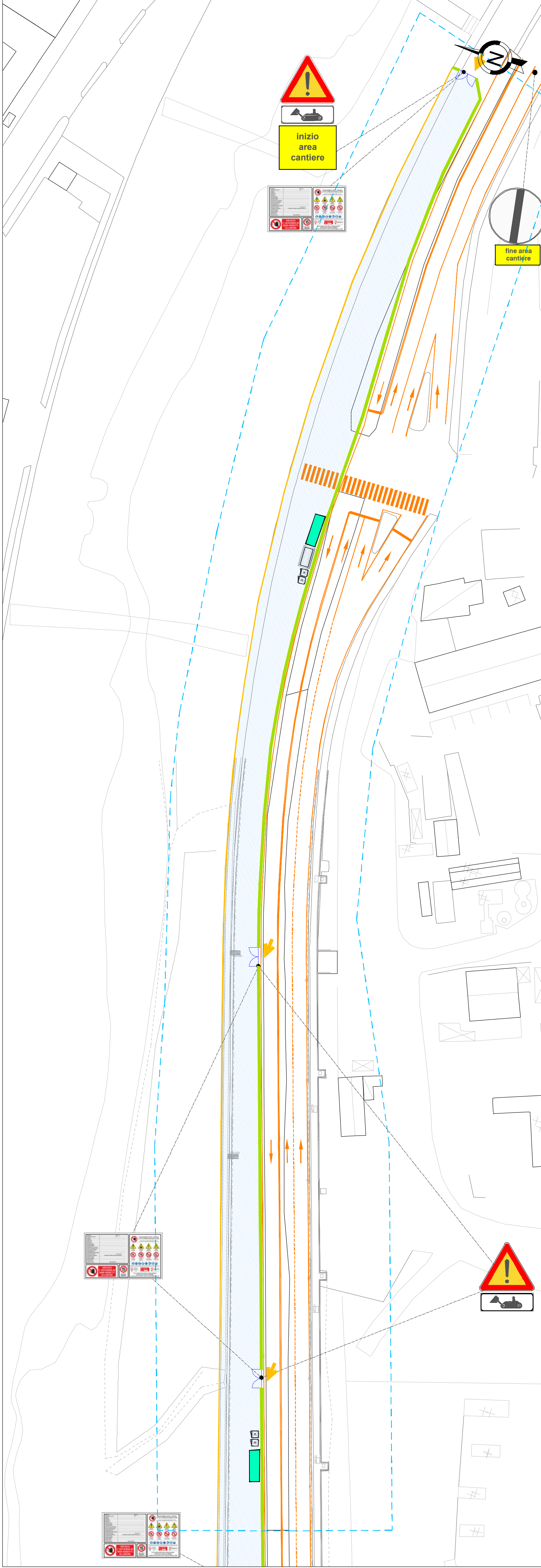
CANT A0 - FASE 1 - scala 1:500 - Realizzazione layout di cantiere - modifica o realizzazione nuovi SSV - Sistemazione marciapiedi nord VIABILITA' - Chiusura una corsia in direzione sud su via Gelasio Adamoli VIABILITA' ALTERNATIVA - Via Molassana
