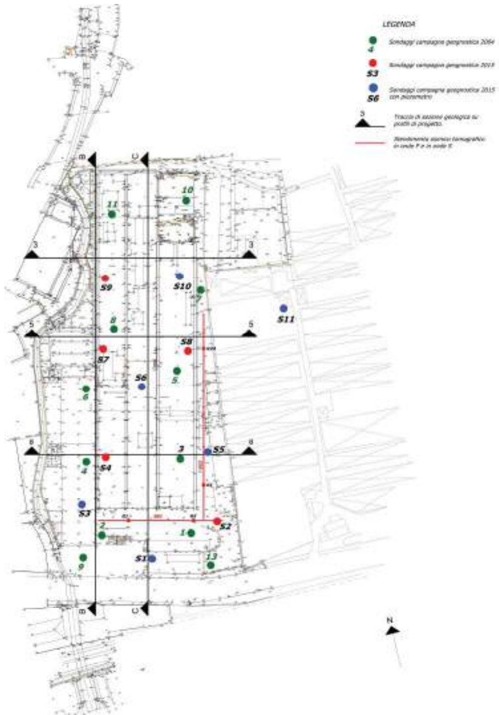
Figura 2: Ubicazione sondaggi nell'area ex Stabilimento Verrina di Genova – Prà.
