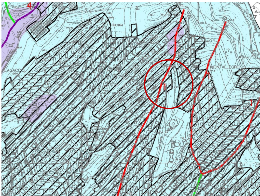
Stralcio carta Idrogeologica del Piano di bacino, ambito 14: terreni permeabili per fessurazione e/o fratturazione interessati da tessuto urbanizzato continuo impermeabile con substrato relativo (area a tratteggio).
