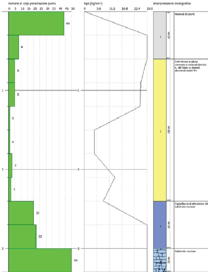
Fig. n° 22: Prova penetrometrica Dp2
