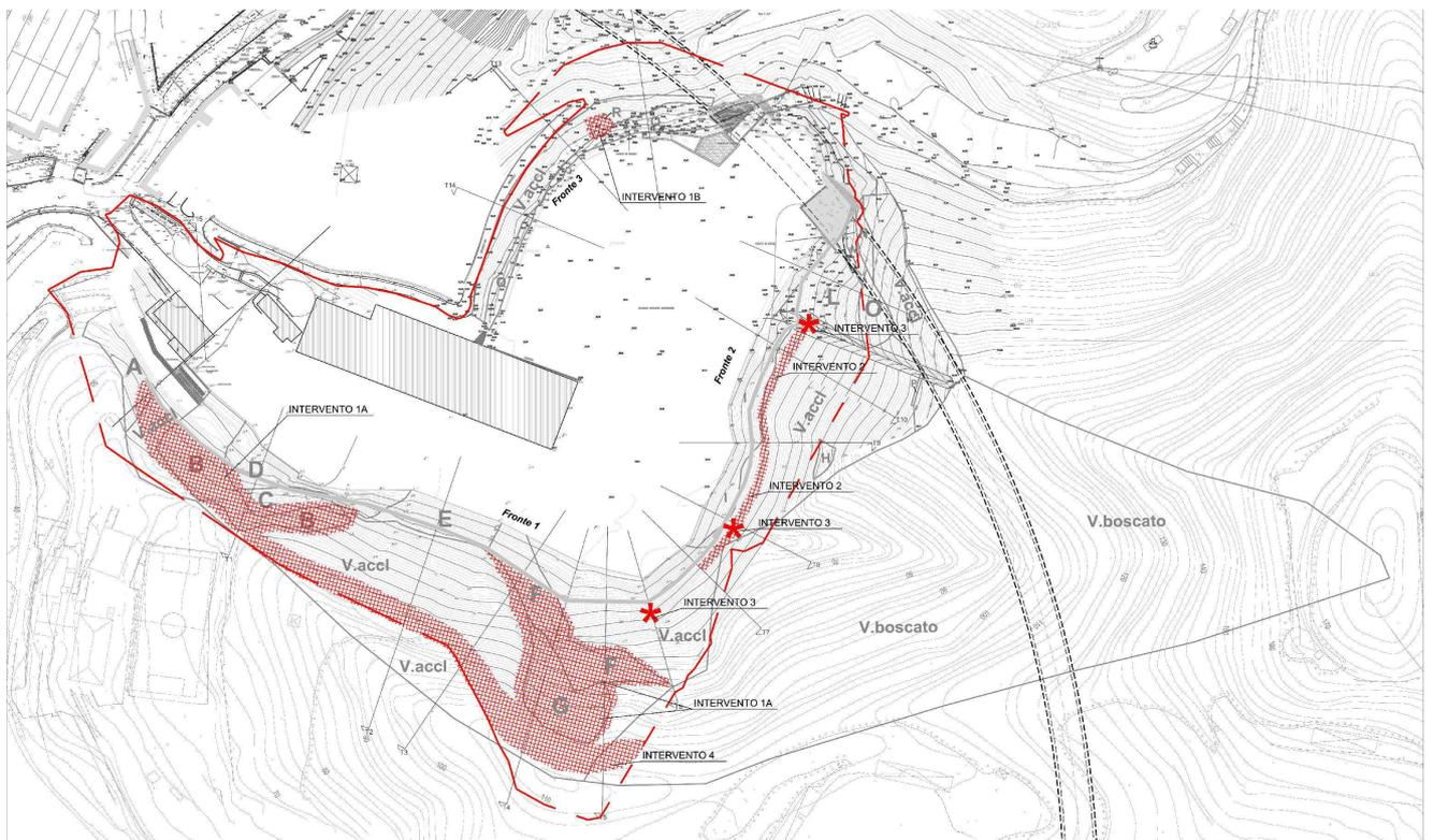
FIG. 12: messa in sicurezza della ex cava Derrick di Genova Borzoli – planimetria degli interventi.
